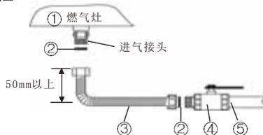
① 燃气灶 ② 密封圈 ③ 金属波纹管
